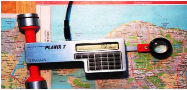
جهاز البلانيميتر رقمي (ذو عجلة دوارة)
