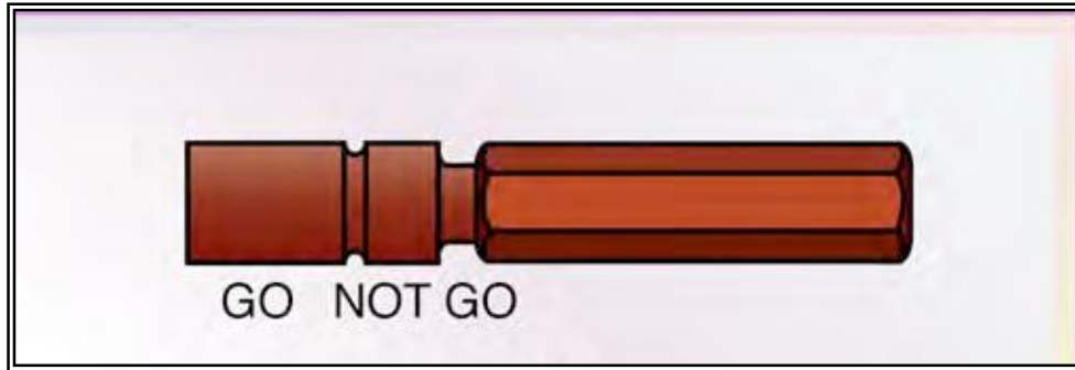
الشكل رقم (14-3) : مُحدد قياس سدادي ثنائي متتابع
