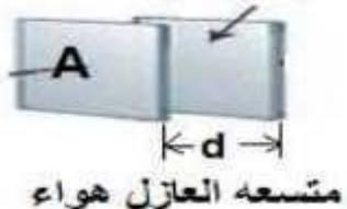
$$C_0 = \frac{\text{سماحية الفراغ} \times \text{مساحة لوح المتسعة}}{\text{سمك العازل}} \quad \dots \dots \dots 2$$
