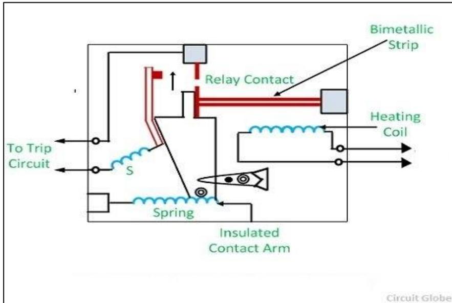
يعتمد عمل هذا النوع من المرحلات على التأثير الحراري الذي يولده التيار حيث تعتمد آلية العمل على مبدأ التمدد والتقلص الحراري للألواح ثنائية المعدن (bimetallic strip). بمجرد أن يبدأ التيار بالتدفق خلاله ، تبدأ درجة الحرارة في الارتفاع. كلما زاد تدفق التيار الحالي ، ارتفعت درجة حرارة لوحات الوحدة
