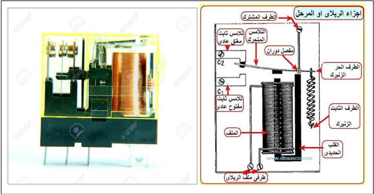
ولغرض فهم الية عمل المرحل انظر الى الدائرة في الشكل أدناه, تشكل هذه الدائرة تغذية مصباح كهربائي عن طريق المرحل . في الحالة الاعتيادية تكون ملامسات المرحل مفصولة عن الدائرة الخارجية وعند تحفيز ملف المرحل تتولد فيه قوة مغناطيسية تجذب ملامس المرحل ليتم اىصال الدائرة وتسمح بمرور التيار الى الحمل .
