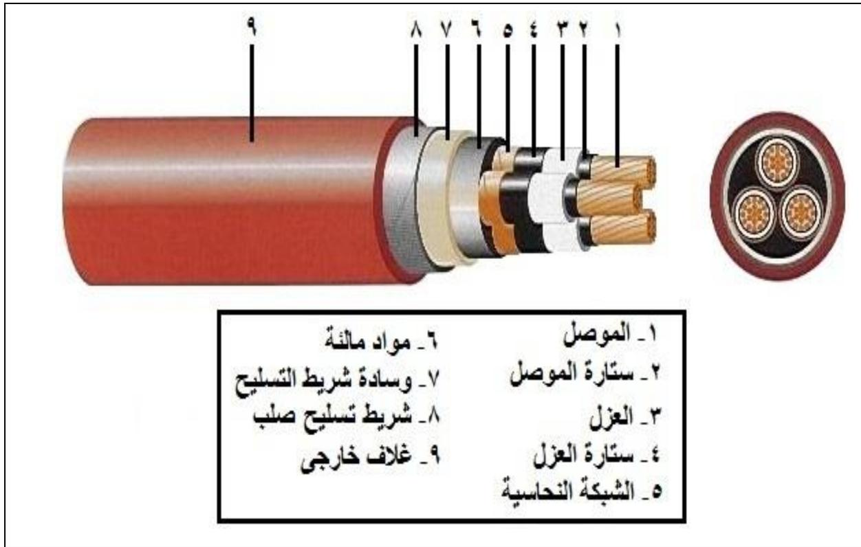
شكل 4- الاجزاء الرئيسية في القابلو الكهربائي
